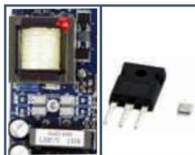
La riduzione delle dimensioni è stata possibile grazie all'utilizzo di componenti elettronici di ultima generazione: la foto mostra la miniaturizzazione di un dispositivo di potenza ed il suo utilizzo negli amplificatori PRIMA.
