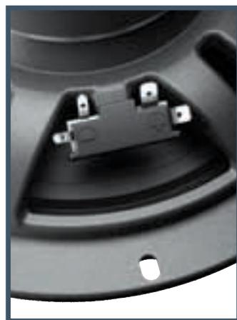
Per le vetture che prevedono un woofer da 8 pollici come componente OEM, i tecnici Audison hanno realizzato l'AP 8 che grazie alla grande superficie di emissione garantisce maggiore energia in gamma bassa al punto da assicurare un'ottima performance anche senza l'utilizzo di un subwoofer che in molti casi può risultare difficile da installare per mancanza di spazio.
